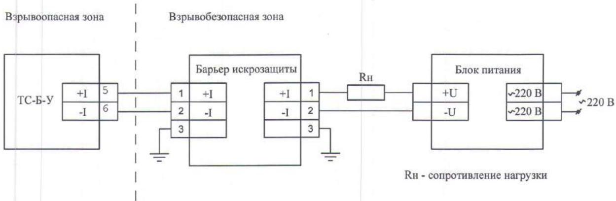
Номера клемм (1-4) указаны на клеммной головке термопреобразователя, клеммы 5,6 см. рисунок В.1
