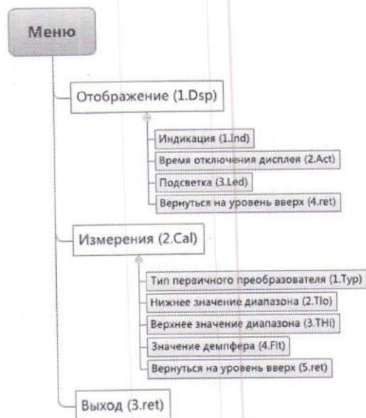
Рисунок 1 – меню индикатора с преобразователем температуры
