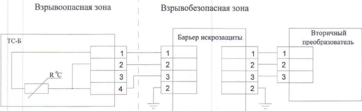
Рисунок В.4 Схема подключения взрывозащищенного ТС-Б, с видом взрывозащиты «искробезопасная цепь» уровня «ia», с 3-х проводной схемой подключения к вторичному преобразователю (устройству индикации).
